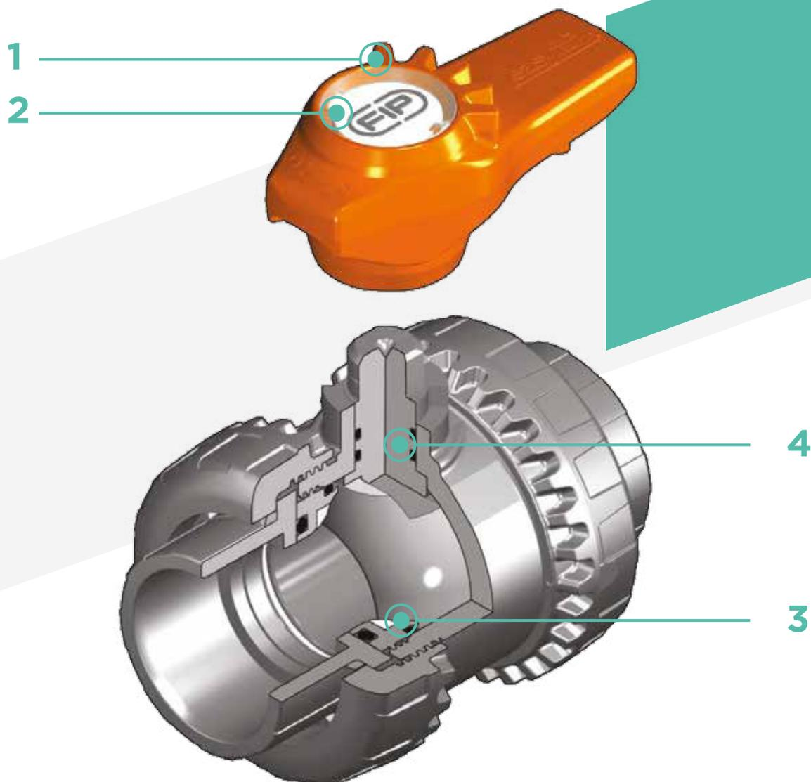
**1 Maneta multifunción ergonómica Easyfit** que puede colocarse en dos posiciones con **mando para la regulación del apriete de las tuercas** y que puede utilizarse como llave para la **regulación del soporte de los asientos de estanqueidad de la bola**. El uso de la maneta está especialmente indicado para operaciones de **mantenimiento** donde se trabaje **en espacios reducidos** y de difícil acceso
