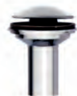
Con chapa de acero inox. Ø70 mm, y tapón de apertura/cierre Click-Clack Ø 66 mm.
