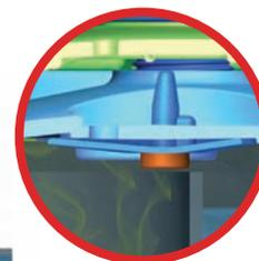
Válvula de aireación abierta
