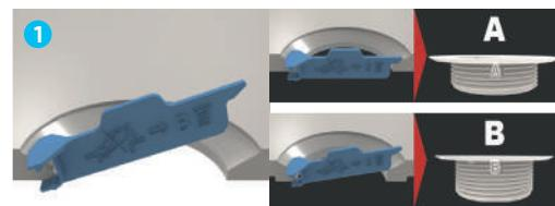
Mide y selecciona tu adaptador roscado según el espesor de tu plato.
