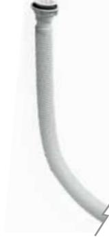
Rebosadero vertical circular en ABS blanco, Ø35.5 mm. Tubo Ø25 mm, 760 mm de longitud.
