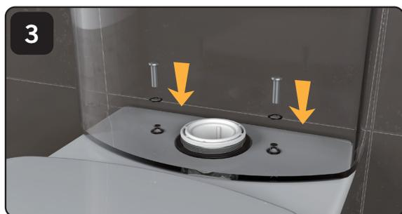
Coloque nuevamente el tanque bajo, y fíjelo al inodoro con el conjunto de tornillos y juntas suministrados.
