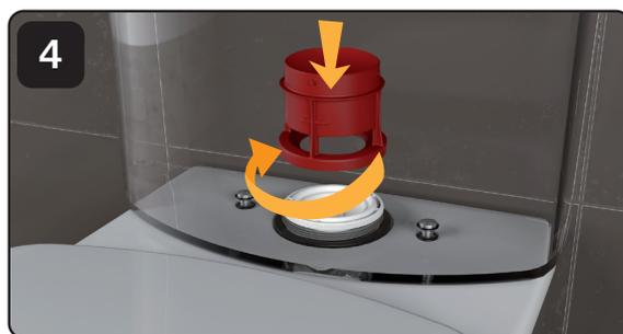
Rosque el adaptador a bayoneta sobre la base roscada del interior del tanque.
