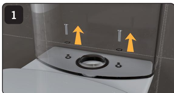
Retire el tanque bajo, para ello, afloje los tornillos y suelte el mismo.
