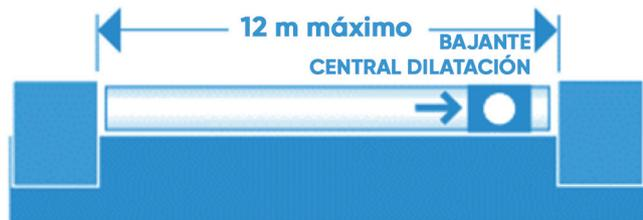
Si la instalación es en línea recta con bloqueo en ambos extremos y de longitud superior a 12 metros, utilizaremos 2 bajantes laterales a encolar y una funda central de dilatación.
