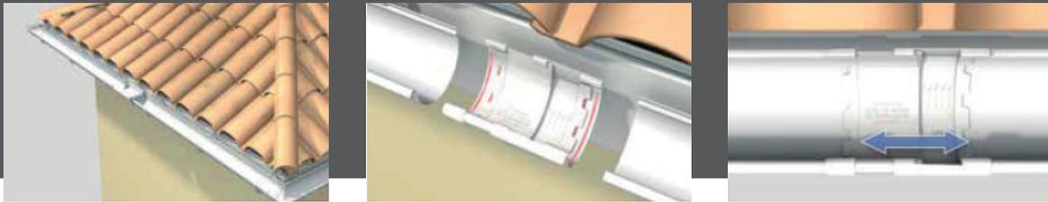
La unión de dilatación se posiciona entre dos puntos fijos (por ejemplo 2 ángulos). La unión se encola por sus dos extremos. La parte móvil se debe situar sobre la temperatura ambiente existente (dispone lectura interior). Gracias a la junta interior, los movimientos de dilatación y contracción del perfil son absorbidos. Estética y fácil de instalar, permite absorber la dilatación sin romper la línea de agua.
