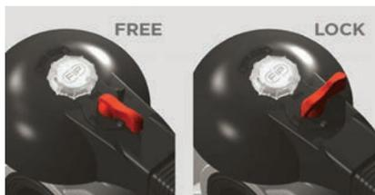
Gracias a la maneta multifunción y al botón de maniobra rojo colocado en la palanca, es posible efectuar una maniobra de 0° - 90° y una maniobra graduada mediante las 10 posiciones intermedias y un bloqueo de retención: la maneta puede bloquearse en cualquiera de las 10 posiciones simplemente utilizando el botón de maniobra Free-Lock. Es posible, además, instalar un candado en la maneta para evitar que la instalación sufra manipulaciones.
