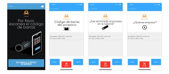
El proceso de fusión debe iniciarse en la unidad de fusión FRIAMAT o mediante el botón «Start» (Inicio) de la app FRIAMAT
