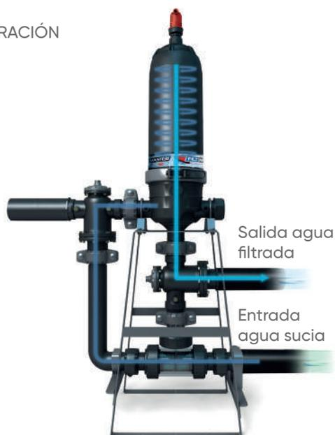
Durante la fase de filtrado, la unidad MasterONE trabaja como un filtro de anillas tradicional. El agua sucia pasa a lo largo de la malla del filtro integrado en la T interior y activa la limpieza del cartucho de filtrado del filtro de malla.
