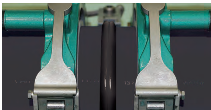
Tubería PE100 Flexipol en la etapa final del proceso de fusión a tope.
