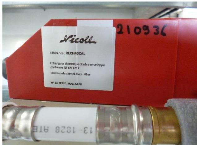
Identification de l'échantillon testé (n° série fabricant)
