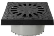
Sumidero Sifónico Autolimpiante con rejilla de fundición. Clase C-250 acorde EN-124 (idóneo para parkings y paso de vehículos).
